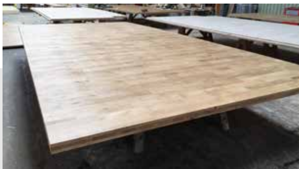
Un panneau CLT chêne en sortie de presse.
